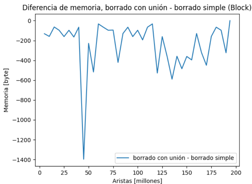
Figura 8: Diferencia de memoria ocupada entre el borrado con unión y el borrado simple
