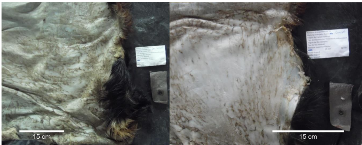
Figura 26 Experimento 20 Raspado sobre cuero. Antes y después de fase 2
