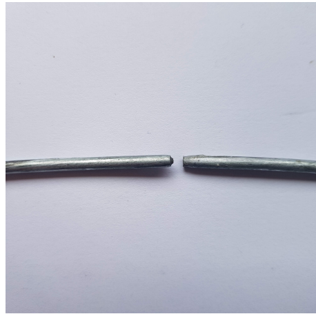
(d) Alambre de acero de 2.95 [mm] 4.
