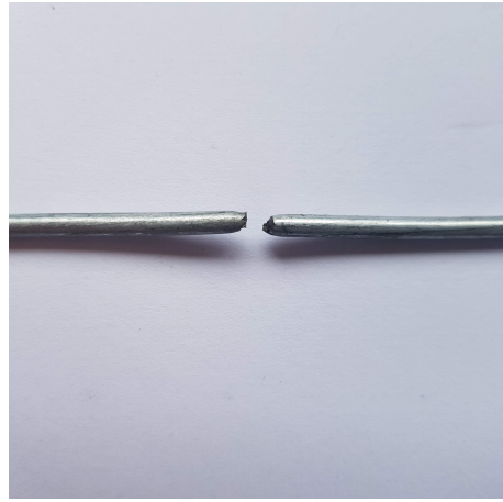
(b) Alambre de acero de 2.95 [mm] 2.
