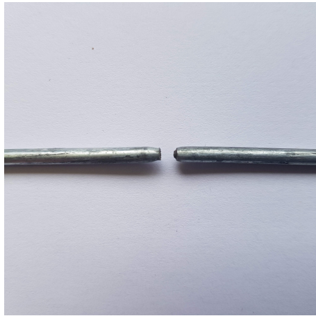
(c) Alambre de acero de 2.95 [mm] 3.
