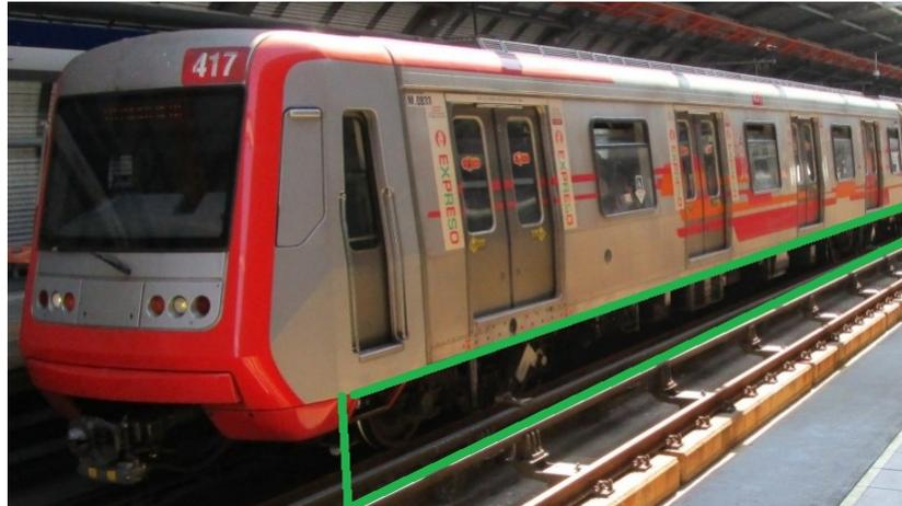
Figura 2.3: Bajo bastidor.[1]
