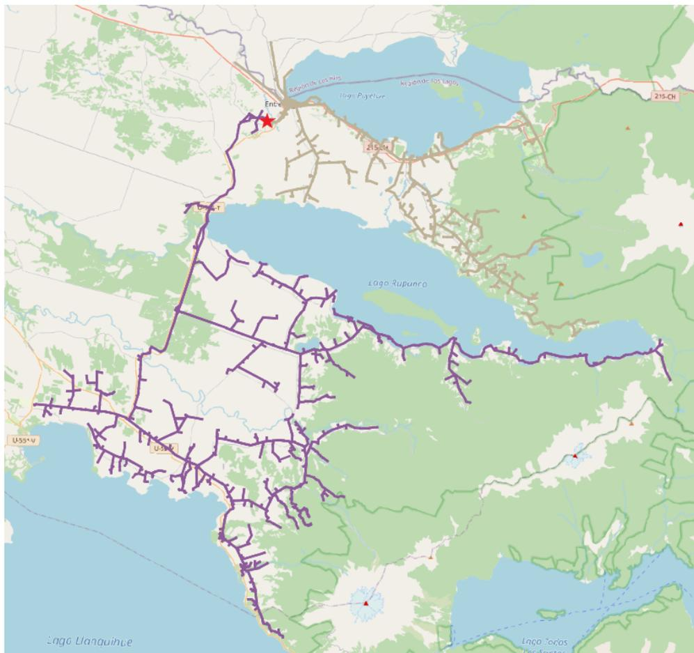
Figura A.1: Red de media tensión modelada de la subestación Aihuapi. En morado el alimentador 428 y en gris el alimentador 405. La estrella roja denota la posición de la subestación primaria.
