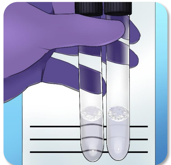
Figura 5. Comparación de suspensión con tubo Standard de McFarland 0,5
