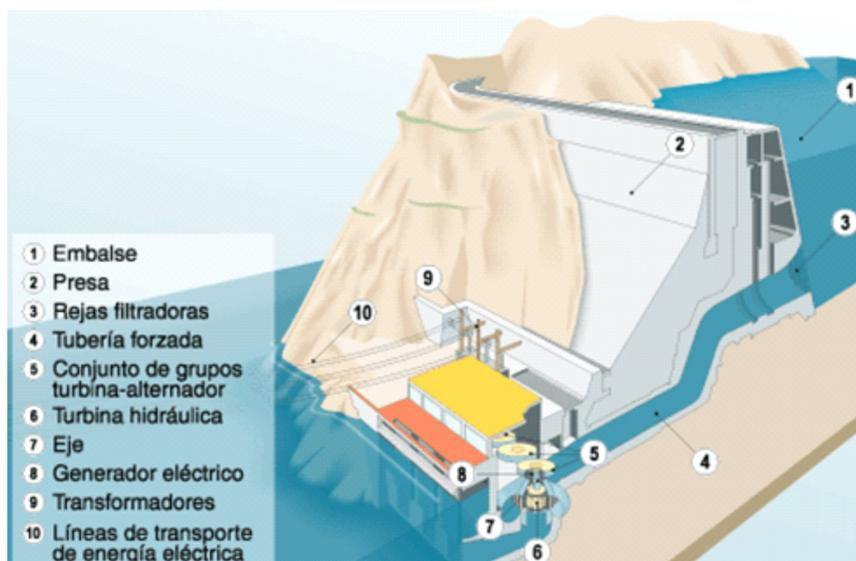
Figura 2.1: Diagrama de central hidroeléctrica con sus principales componentes. <sup>1</sup>
