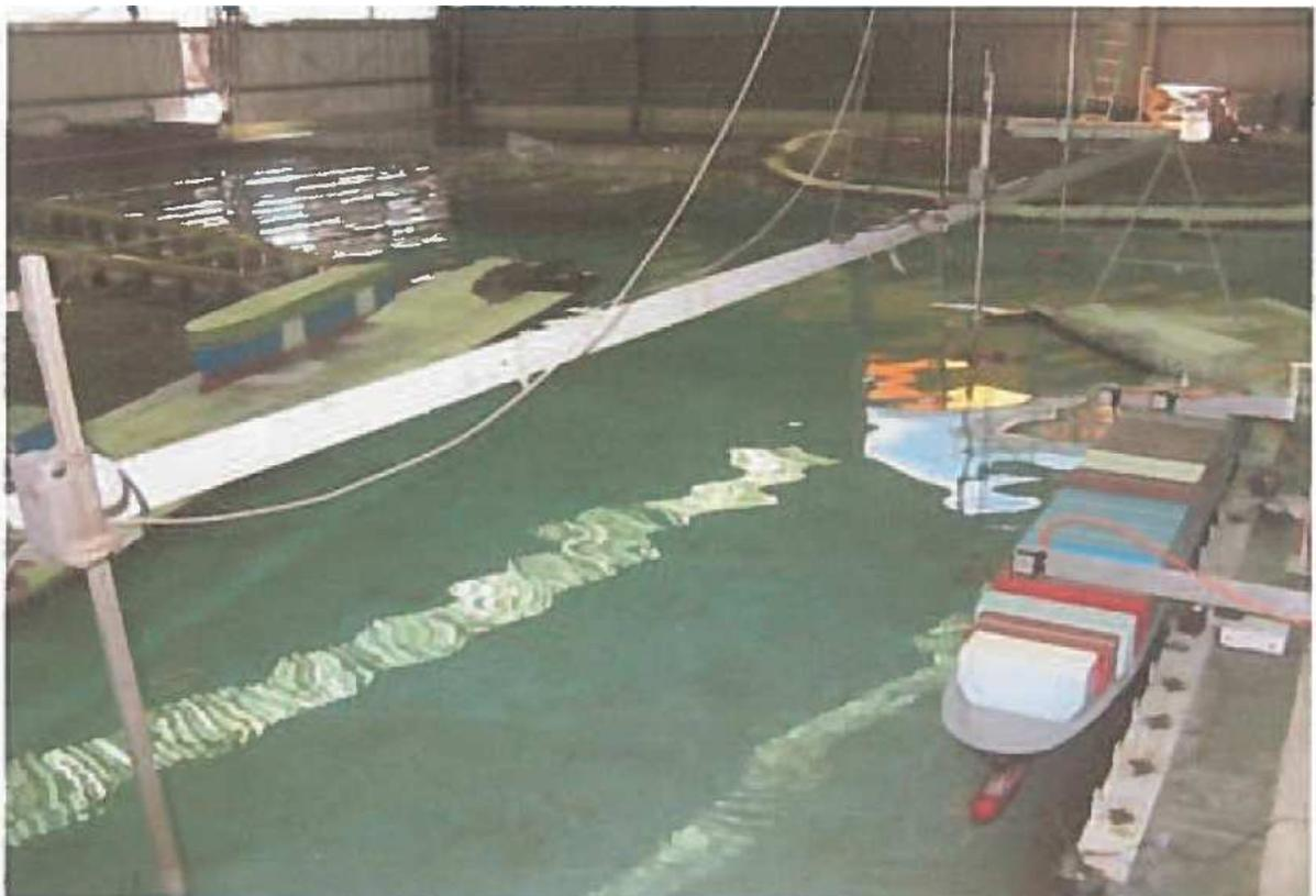
Figura 3-8 Ubicación Buque Porta Contenedores a escala 1:125 en Modelo Físico en INH
