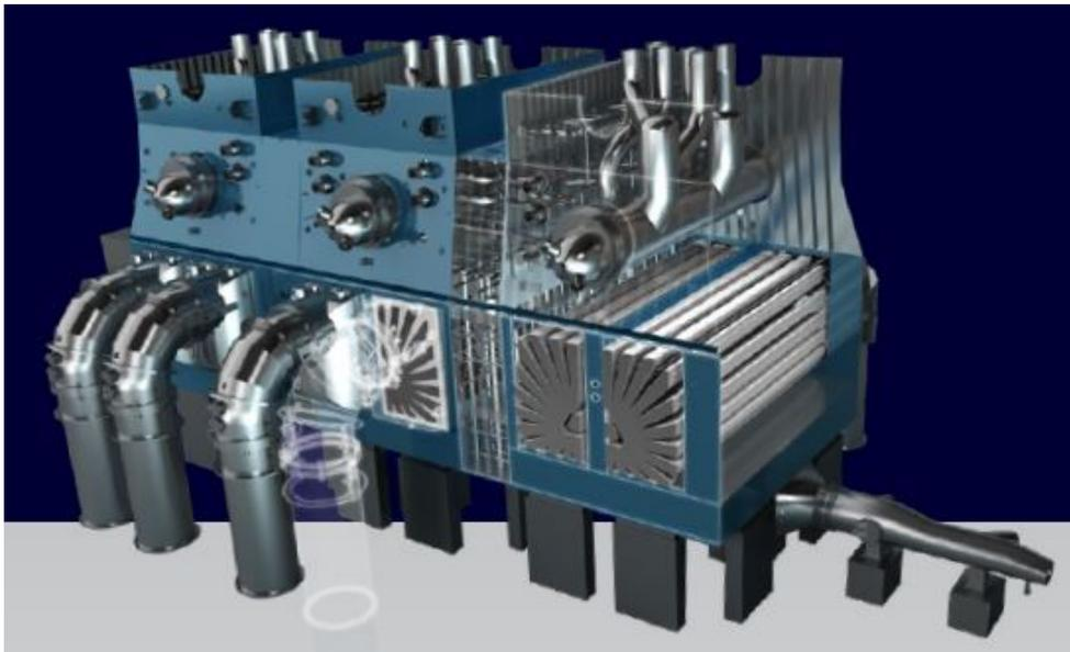
Figura 4.11: Esquema del condensador General Electric [48].
