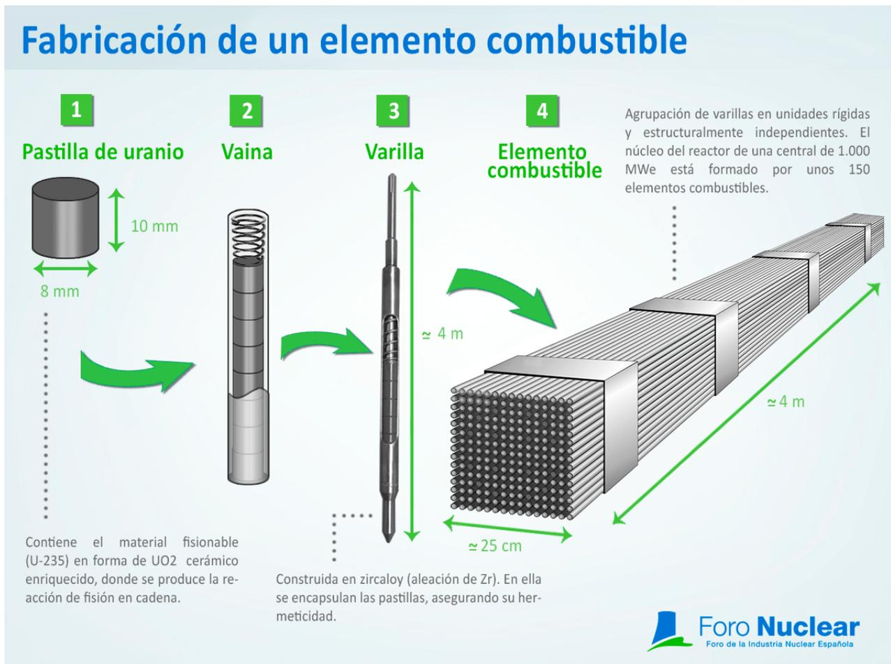
Figura 2.6: Etapas de fabricación del combustible nuclear. [14]
