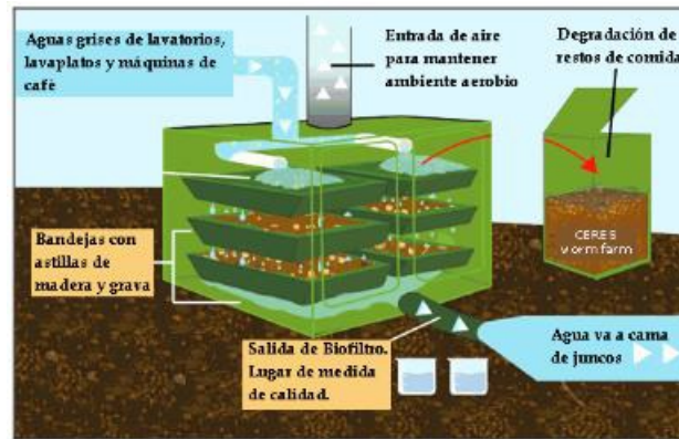
Figura 6.8: Esquema de sistema de Australia. Biofiltro Aeróbico CERES.[25]
