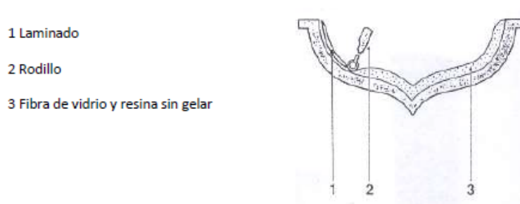
Figura 3.2: Proceso de laminación manual [3]
