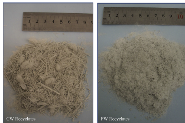
Figura 3.11: FRP grueso y fino respectivamente, producto de reciclaje mecánico. [17]
