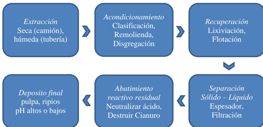
Figura 6: Operaciones Unitarias principales para el Diseño Plantas de Relave (Estay, 2017)
