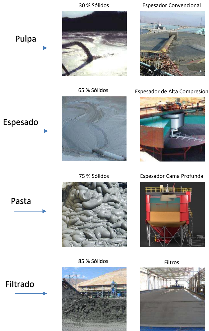
Figura 3: Tipos de relaves y espesadores usados respectivamente (Golder Associates, 2013).
