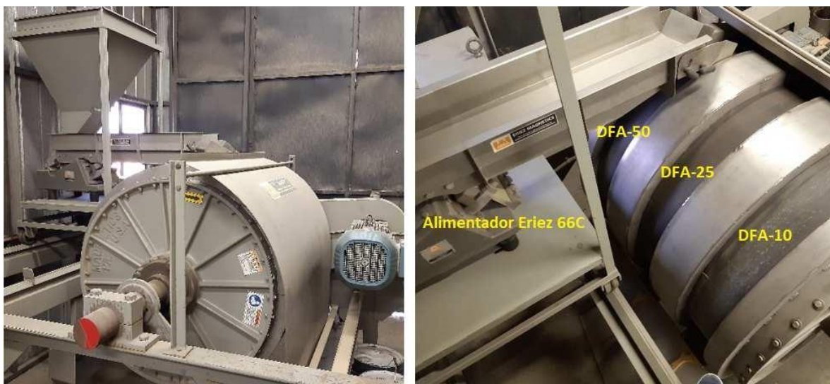
Figura A2: Equipo de pruebas piloto en seco DFA marca Eriez Magnetics.
