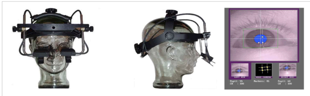
Figura 3: Sistema de Eye Traker utilizado para realizar el registro de diámetro pupilar. A la izquierda, el sistema de montaje y cámaras. A la derecha el setup para visualizar el estado de los ojos y posición de la cabeza en el registro a tiempo real.
