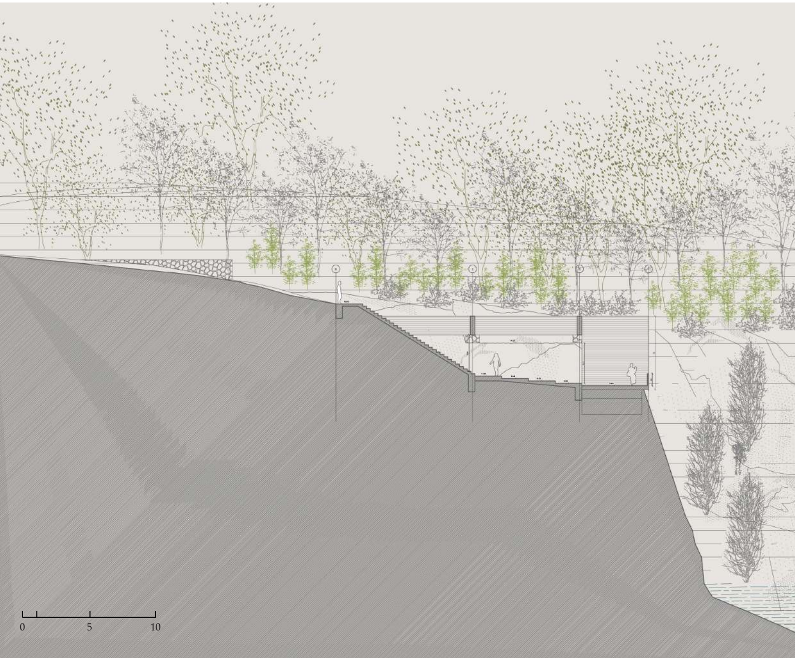
CORTE LONGITUDINAL MIRADOR SUBTERRÁNEO
