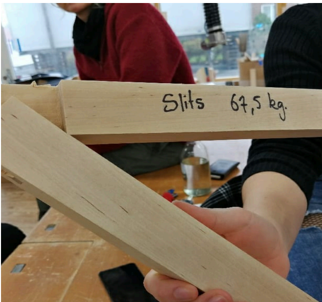
Serie de imágenes, Prueba de uniones en madera y su resistencia. Escuela de oficios Grebbestads Folkhögskola. https://www.instagram.com/p/B4AQW5MpGMC/ ?fbclid=IwAR-1nkLPLefgRNz1xfxudKRSVlqirmzisU7alUxdRFWHaA0dEmTlhH-b_33Ds
