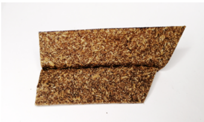
Figura n°34: Prueba de unión de piezas mediante costura (Autoría propia).
