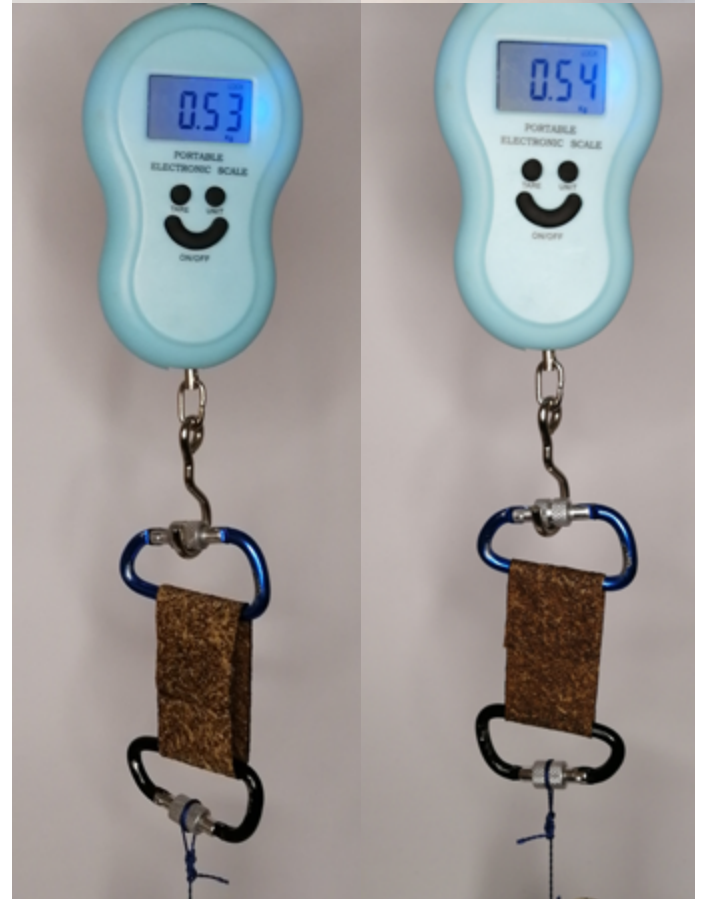
Figura n°63: Lámina pegada con cola soportando una carga de 0,5 kilogramos (Autoría propia).
