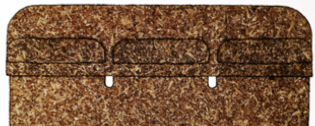
Figura nº40: Prueba de ensamble por pestañas (Autoría propia).
