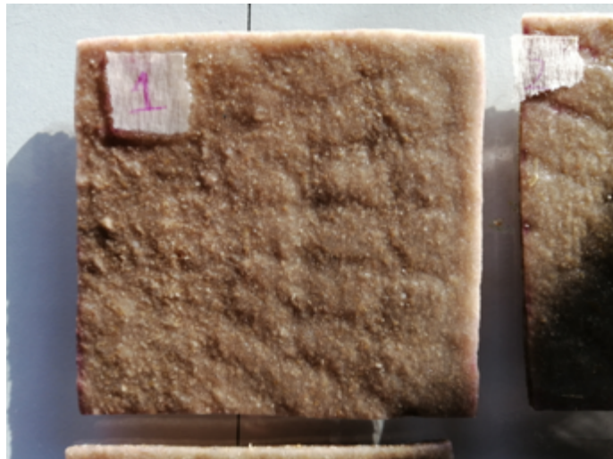
Figura n°56: Muestra 1 después de 24 horas sumergida en agua (Autoría propia).
