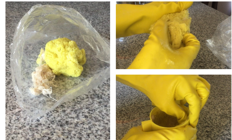
Figura 25 b. Proceso de mezcla. Izquierda disposición de algodón en bolsa, derecha mezcla y moldeo.
