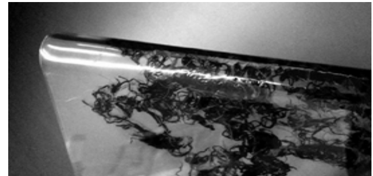
Figura 14. Material compuesto en base a mezclilla y PMMA. Fuente: Gómez et al., 2017.
