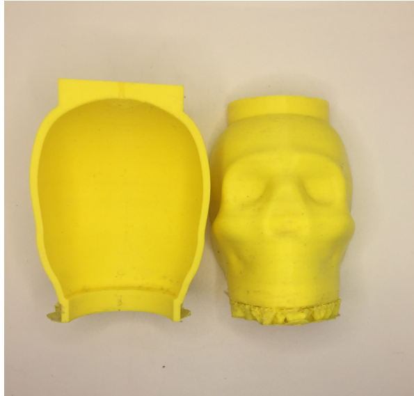
Figura 37. Molde calavera, impresión 3D. Elaboración propia.
