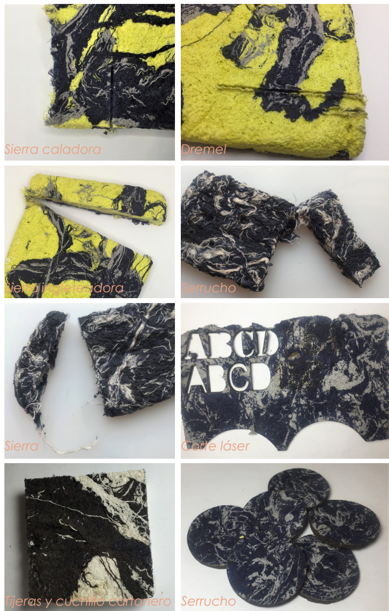
Figura 71. Probetas de ensayo de corte. De arriba a abajo, de izquierda a derecha: Sierra caladora, Dremel, Sierra ingleteadora, Serrucho, Sierra, Corte láser, Tijeras y cuchillo cartonero, y Corte láser. Elaboración propia.
