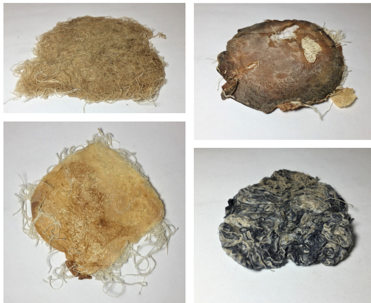
Figura 47. Pruebas de aglomerantes y fibras. Esquina superior izquierda: algodón cera de abeja. Esquina superior derecha: algodón y kombucha. Esquina inferior izquierda: algodón y agar-agar. Esquina inferior derecha: algodón y maicena. Elaboración propia.
