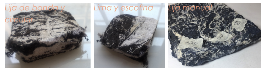
Figura 72. Probetas de ensayo de desbaste. Izquierda: lija de banda y circular. Centro: lima y escofina. Derecha: Lijas manual. Elaboración propia.
