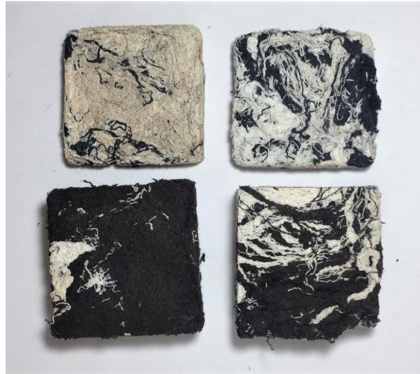
Figura 32. Ensayo de resistencia a rayos UV. Elaboración propia.
