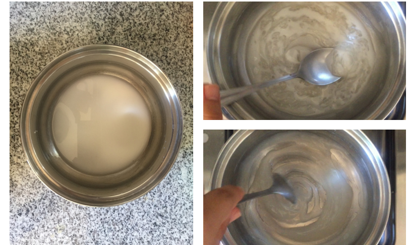
Figura 25 a. Proceso productivo de aglomerante. Izquierda mezcla en frío, derecha texturas esperadas con aplicación de calor.
