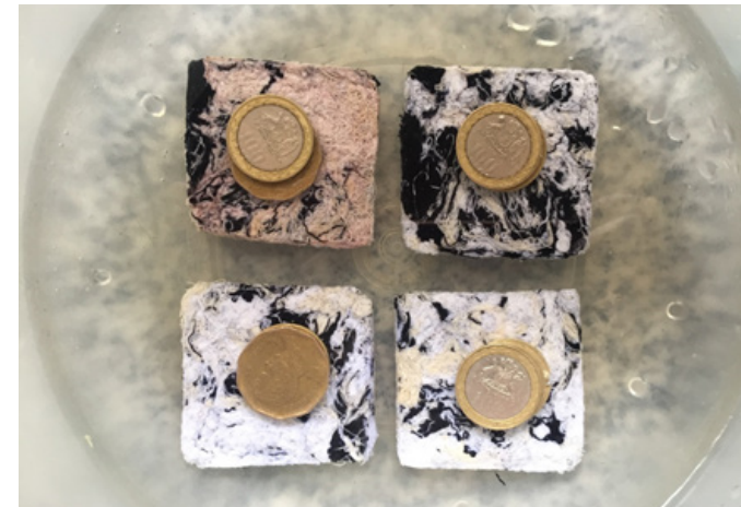
Figura 26. Disposición de probetas a ensayo de absorción de agua e hinchamiento. Elaboración propia.
