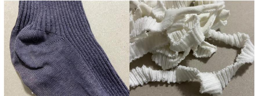
**Figura 146.** Calceta con diferente estructura de tejido y resultado de corte como trapillo - Elaboración propia
