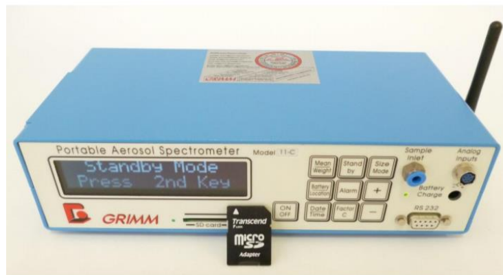
Figura 2 Espectrómetro de aerosoles modelo GRIMM 11-C.
