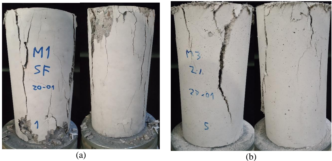
Figura 4.10: Modo de falla de probetas en ensayo a compresión.
