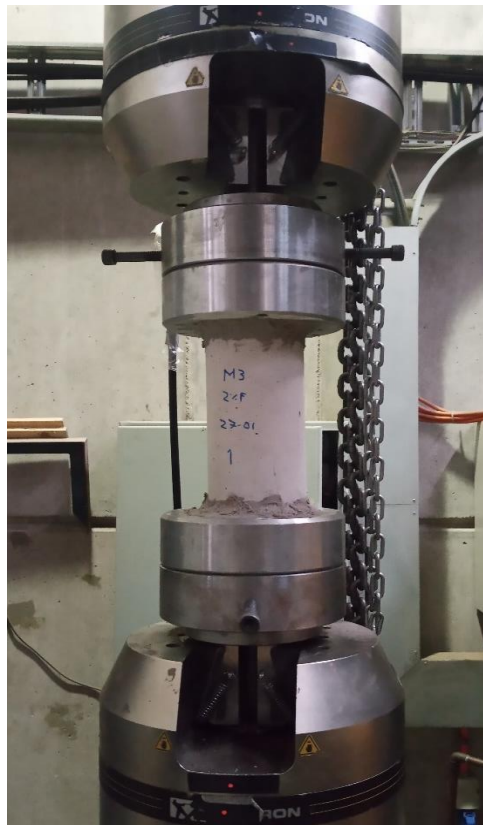
Figura 3.9: Montaje ensayo a tracción directa.
