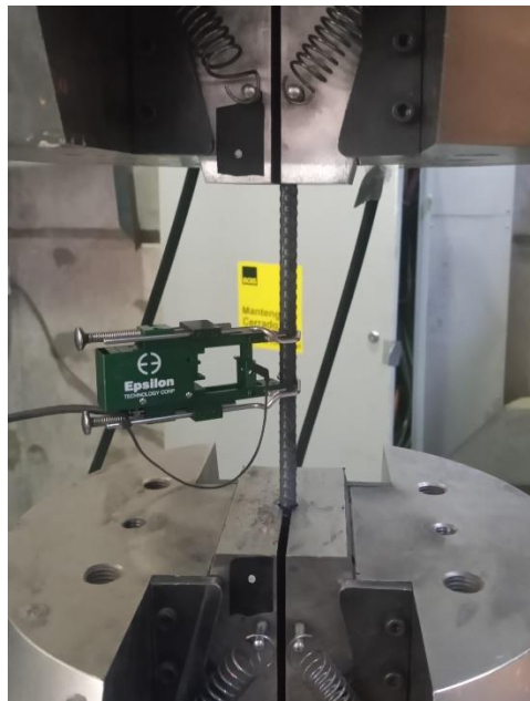
Figura 3.4: Montaje del ensayo a tracción para una barra de acero.
