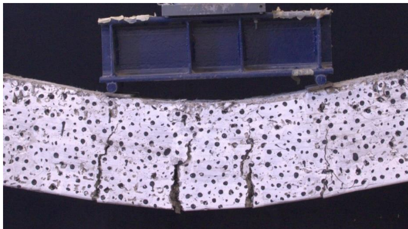
Figura 4.31: Estado final viga VL-2%.
