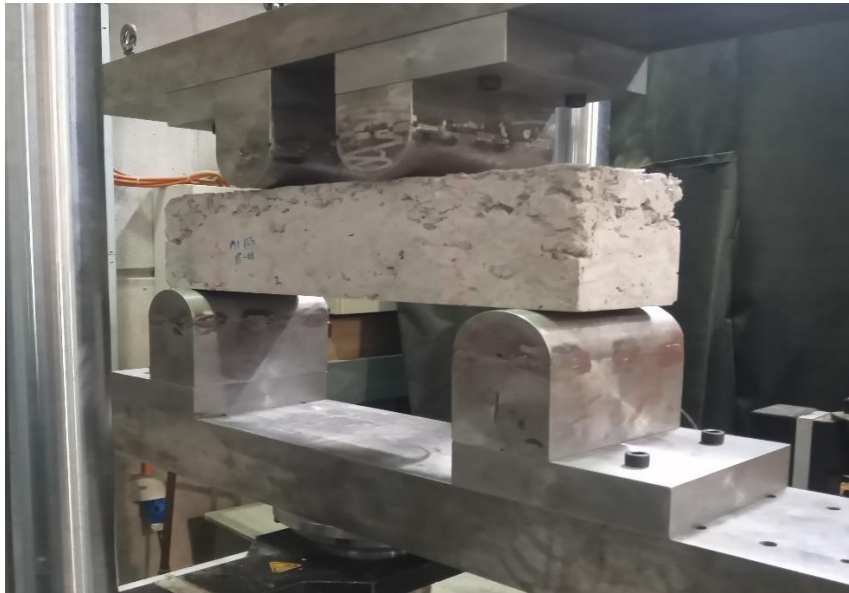
Figura 3.10: Dispositivo montado para el ensayo a flexión de viguetas.
