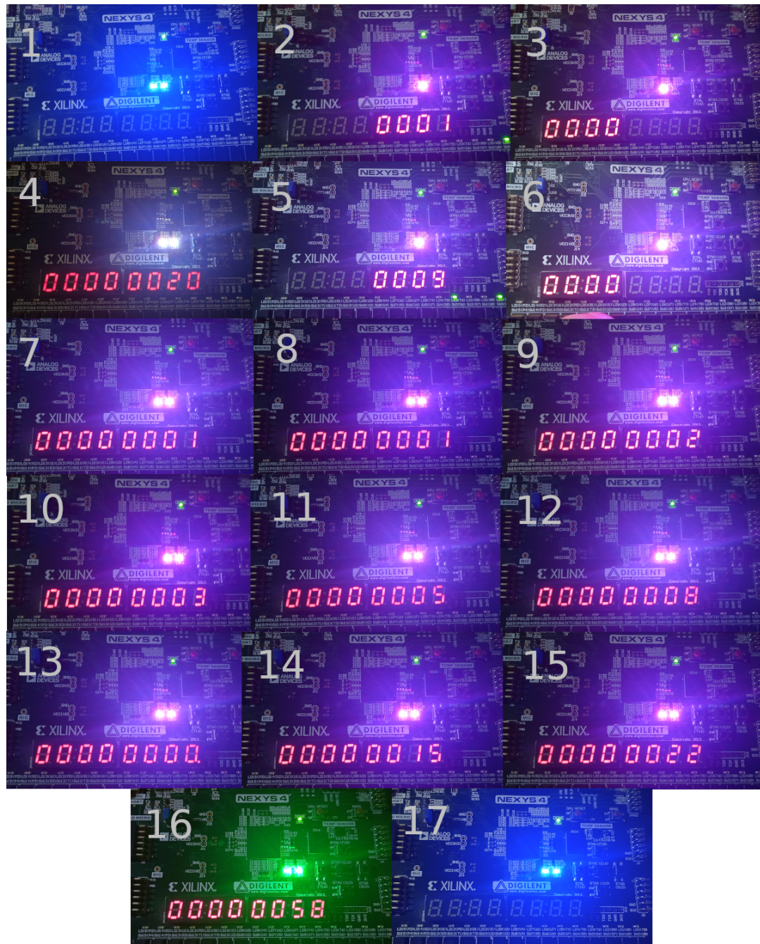
Figura 5.21: Resultado de fibonacci_inputs.s en la Nexys 4 .
