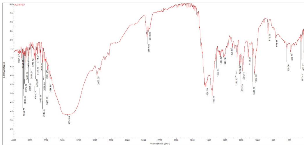
Figura 5.4: Espectro FTIR de una lámina de alginato con 0,1 % de óxido de grafeno.
