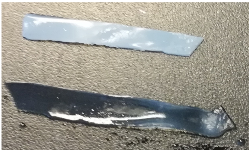
Figura 4.11: En la parte superior una lámina de alginato entrecruzado con AAD y curado con cloruro de calcio por 60 minutos antes de realizar la prueba de flexión, en la parte inferior la misma muestra posterior al ensayo.
