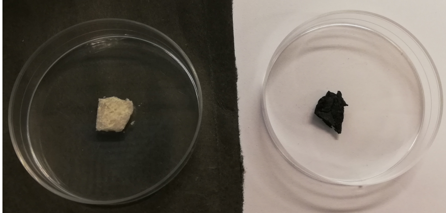
(a) Antes del Ensayo de Hinchamiento
