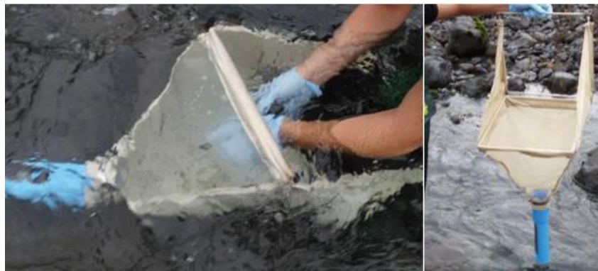
Figura 2. Muestreo de macroinvertebrados bentónicos con red Surber
