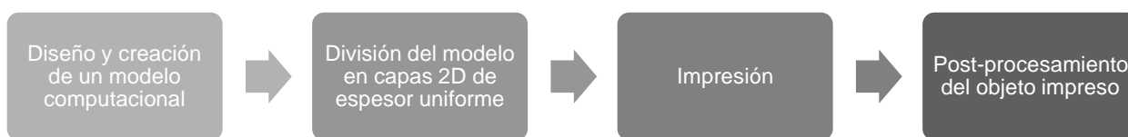
Figura 11: Etapas del proceso de impresión 3D.
