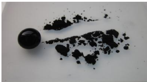
Figura 56: Proceso auto limpiante de una superficie superhidrofóbica cubierta de polvo de grafito, donde una gota de agua de 10 \mu\text{L} adsorbe el carbón activado depositado sobre el material [109].
