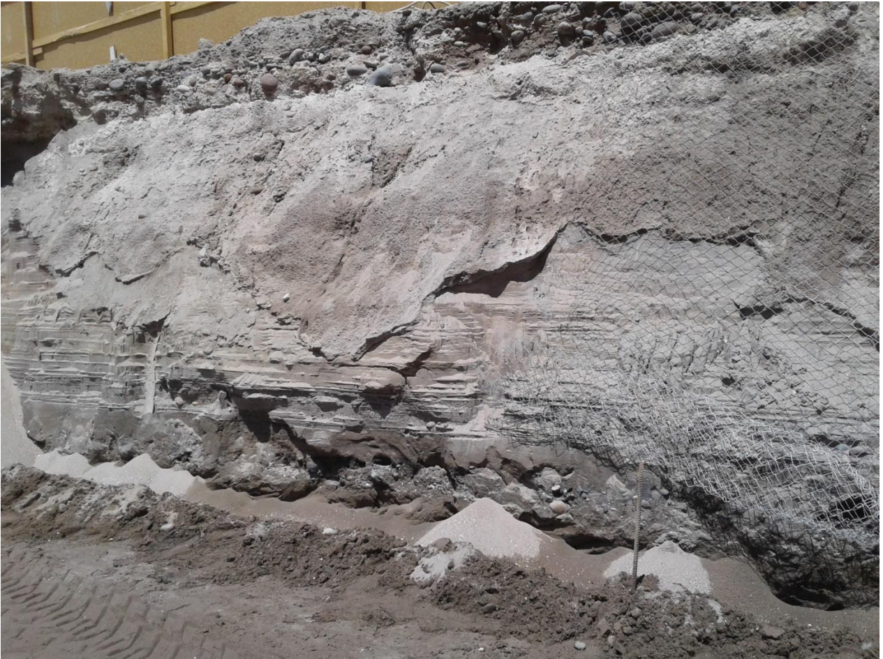
Figura 9. Fotografía calicata en arenas y gravas cercanas a la costa, proyecto Novotel.
