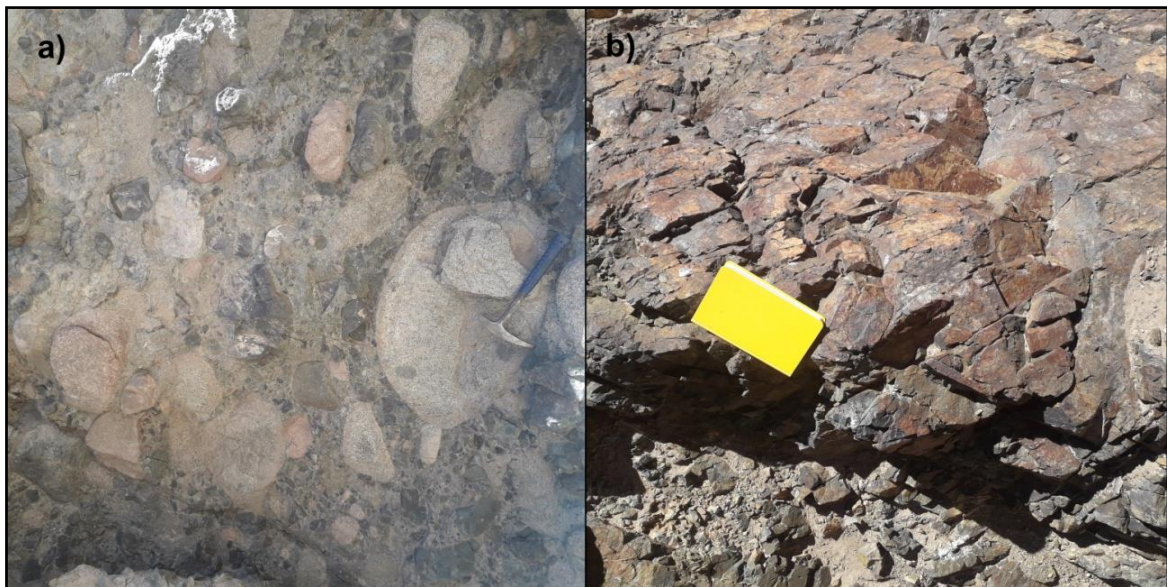
Figura 24: Se muestra la litología de las rocas cercanas a la surgencia de la vertiente Vizcachas. En a) se observa la brecha polimíctica, la cual tiene planos de debilidad rellenos de arena fina y limo. En b) se observa la lava afanítica.
