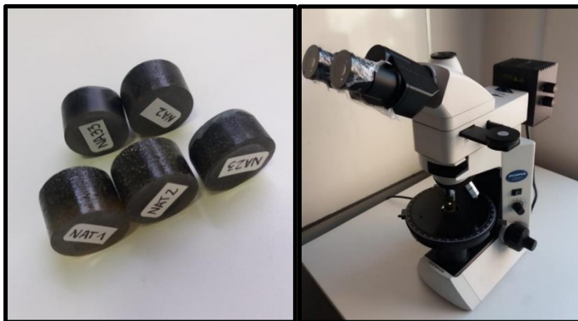
Figura 1.5. Briquetas pulidas (derecha) y microscopio Olympus CX41 (izquierda), usados para estudio petrográfico.
