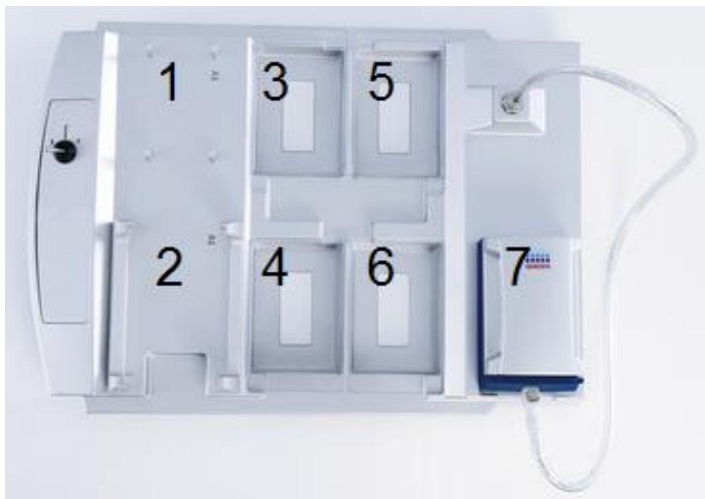
Figura 4. Componentes de la estación de trabajo al vacío de PyroMark Q96. Las posiciones señaladas son el área para la primera placa de PCR (1), área para placa PyroMark Q96 HS (2), solución de etanol 70° (3), solución de Buffer de lavado PyroMark 1X (4), solución de denaturación PyroMark (5) Agua destilada (6 y 7) y la herramienta de vacío (7). Modificado desde QIAGEN<sup>57</sup>.
