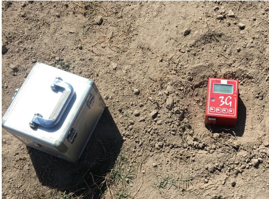
Figura 3. 2: Fotografía tomada en terreno de uno de los Tromino 3G utilizados para captar el ruido sísmico.
