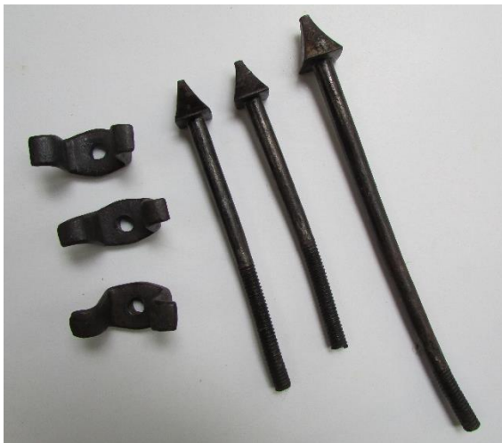
F158 Foto de tuercas y clavos con ácido tánico ya aplicado y secado.
