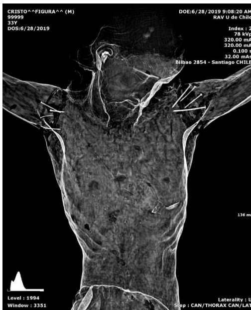
Radiografía de escultura en zona superior donde se evidencia unión de brazos.
