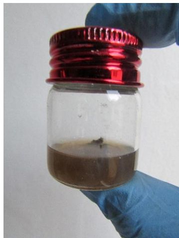
F54 Foto de muestra de cola de unión de brazos diluida en Etanol
