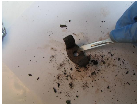
F153 Foto de limpieza mecánica con bisturí en tuerca
