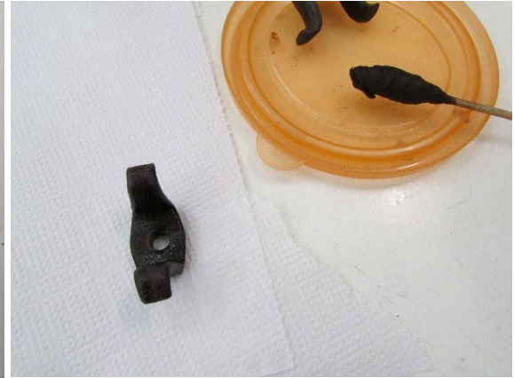
F155 Foto de aplicación de ácido tánico mediante hisopo de algodón.
