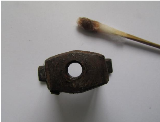
F151 Foto de limpieza química mediante hisopo con Nitro C
