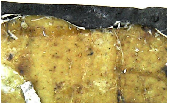
F97 Fotos microscopía óptica en pergamino donde se aprecia la pintura y zona de betún de judea. 1000x.
