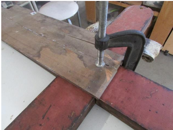
F143 Presión con prensa para pegado de unión.
