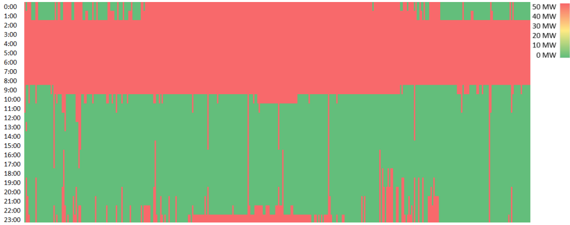
Figura 3.5: Mapa de calor de la potencia horaria de Ciclo Brayton a lo largo del año en la Ubicación 1, operación rápida. GMT-4.
