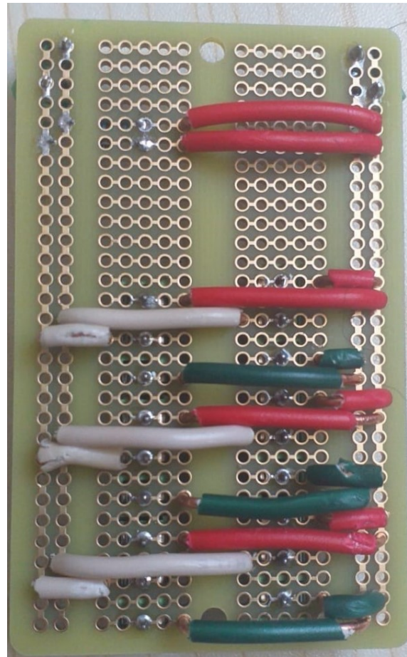
(b) Vista inferior del circuito construido para medir temperaturas en paneles solares.
