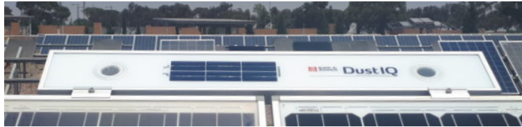
Figura 1.6: Dispositivo DustIQ , que utiliza células solares para determinar la eficiencia de un String [22].
