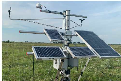
Figura 1.7: Dispositivo Soiling Measurement Kit , que utiliza cuatro paneles solares para su uso [24].
