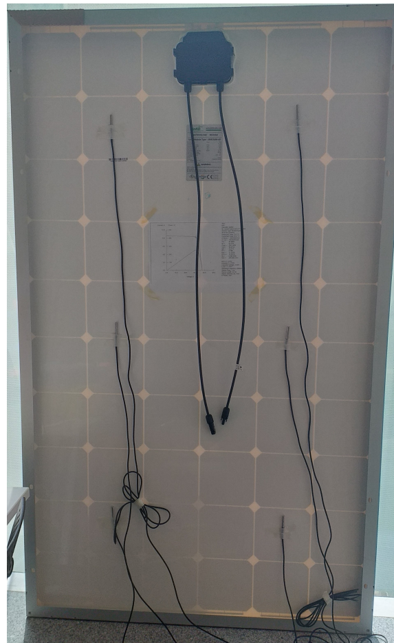
(b) Colocación real de los termómetros digitales por la parte posterior del panel.
