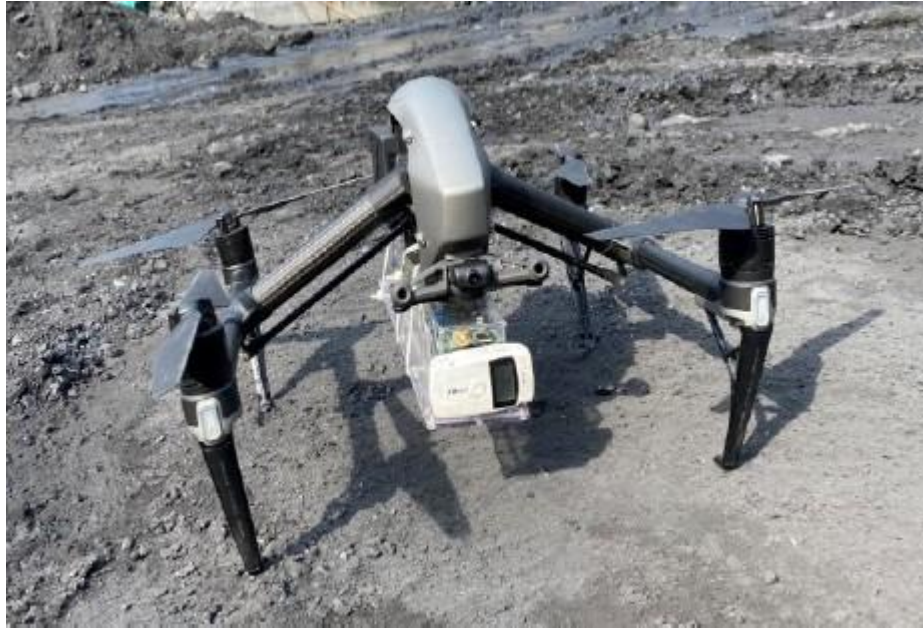
Figura 4.16: Dron DJI Inspire 2 montado con sensores de bajo costo para el monitoreo de calidad del aire. Tomado de [72].
