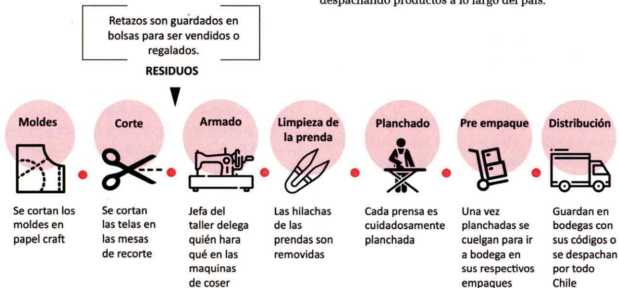
Esquema 4 (Línea de producción lineal de la marca de ropa interior Monamour), elaboración propia.
