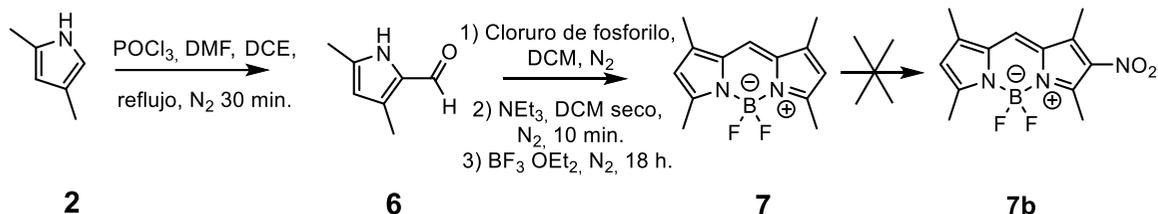
Esquema 8: Síntesis del compuesto 4,4-difluoro-1,3,5,7-tetrametil-2-nitro-4-bora-3a,4a-diaza-s-indaceno.
