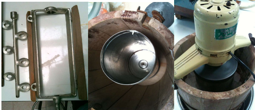
Figura N°2. Aspas, tambor, cubeta y motor de la mantecadora “ Ice Cream Freezer”.
