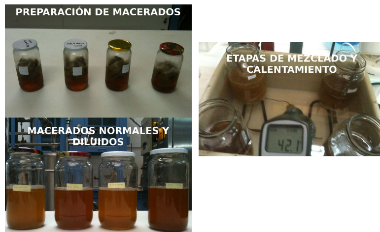
Figura N°7. Elaboración de macerados, etapas de mezclado y calentamiento.
