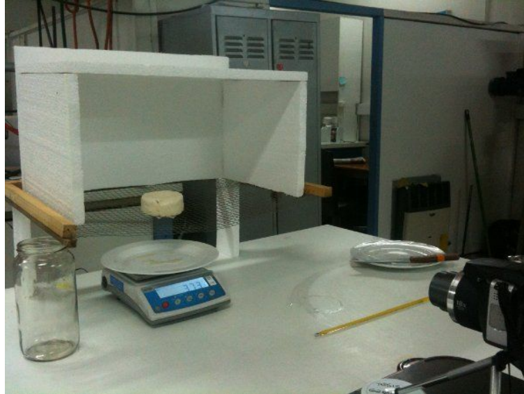
Figura N°4. Montaje para determinar estabilidad térmica de los sorbetes a isoterma 29°C.
