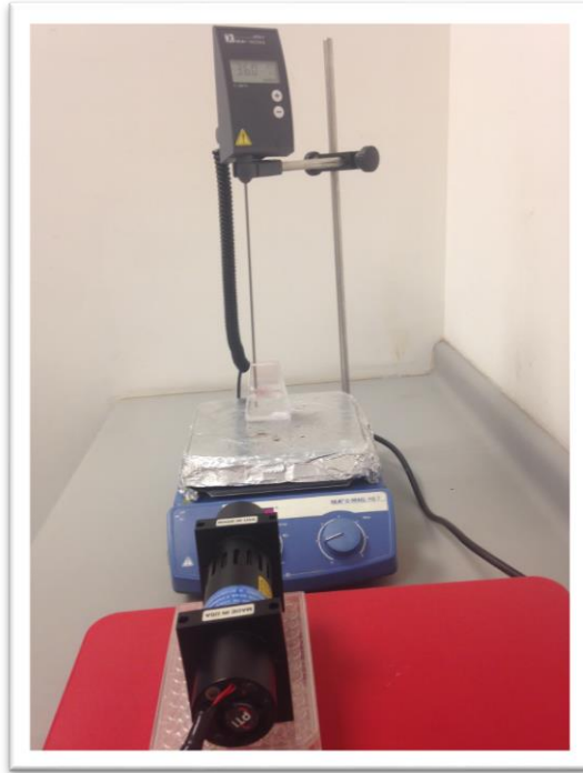
Fig 6. Fotografía que representa el sistema de liberación e irradiación de las pNPs híbridas
