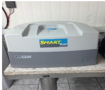
FIGURA 10: Equipo para medir niveles de sólidos solubles y materia grasa de las mezclas de semi-elaborado.
