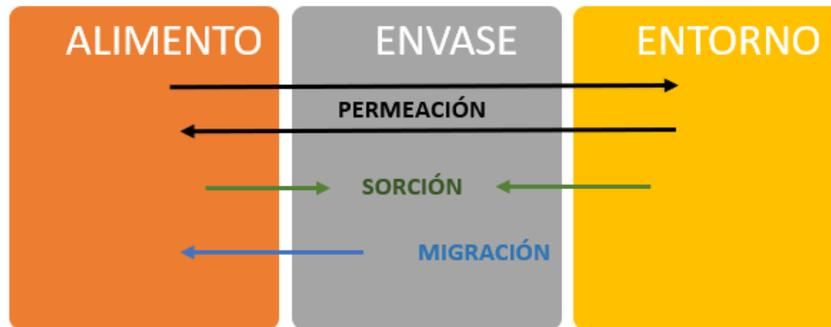
**Figura 1.** Procesos de transferencia de masa en el sistema envase-alimento-entorno
