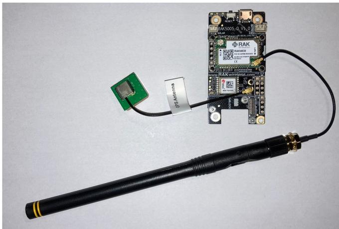
Figura 3.3: Transmisor y localizador empleado para las comparaciones con el chip LR1110, basado en la herramienta Wisblock.
