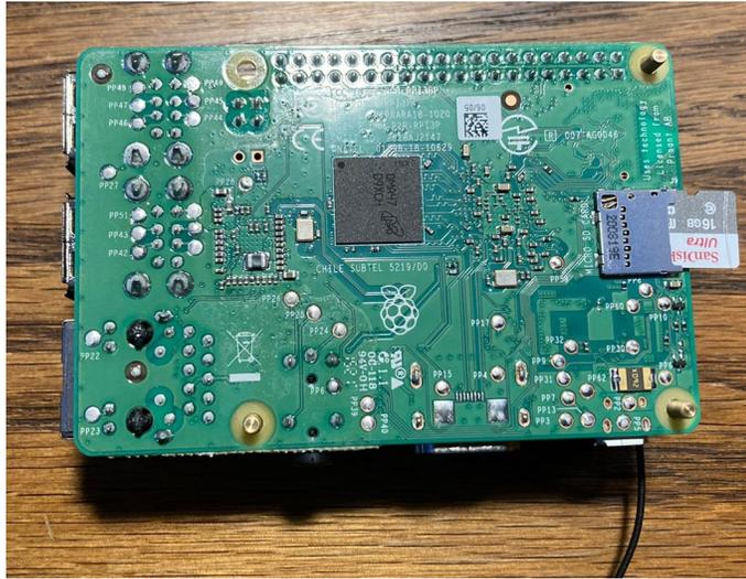
Figura A.4: SD insertada en la parte posterior de la Raspberry.
