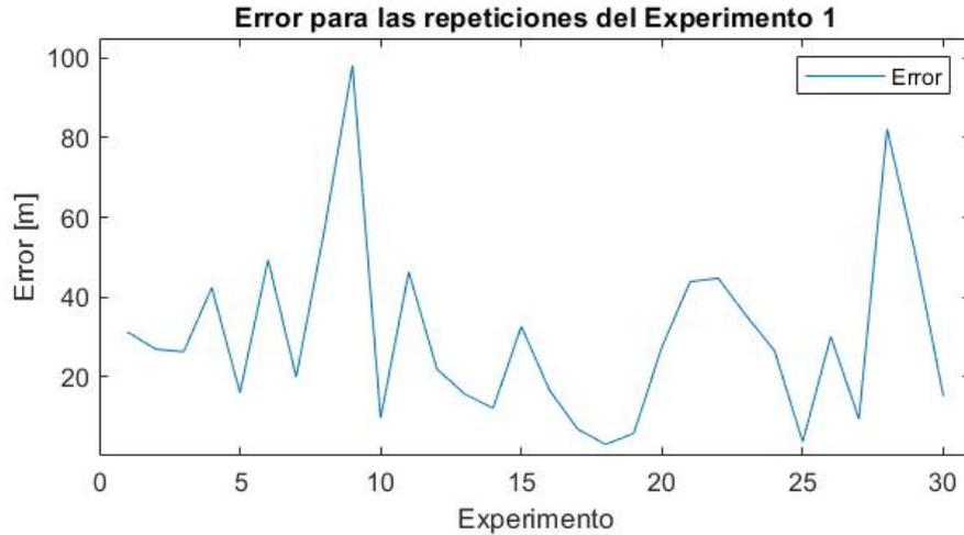
Figura 4.9: Gráfico del error medido entre el punto real y el punto obtenido por el escaneo de Wi-Fi en el experimento 1.
