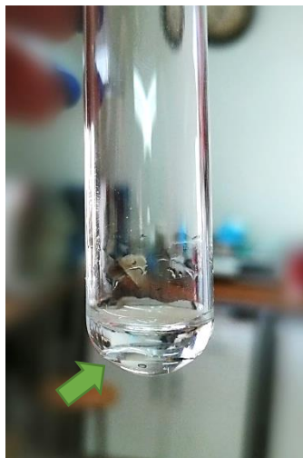
Figura 28. Formación de gota, segunda prueba DLLME.
