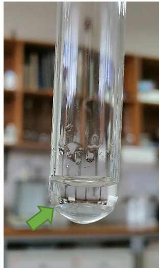
Figura 30. Formación de gota, tercera prueba DLLME.
