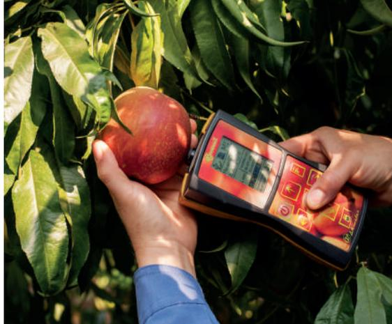
*DA-meter mide la absorbancia de la clorofila de la piel en dos longitudes de onda específicas.*
