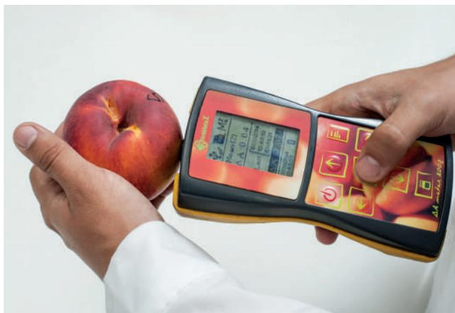
*DA-meter mide la absorción de la clorofila de la piel en dos longitudes de onda específicas.*
