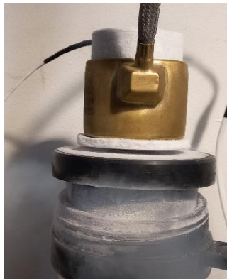
Figura 28: Dispositivo 1 sin poder cerrar por exceso de presión.
