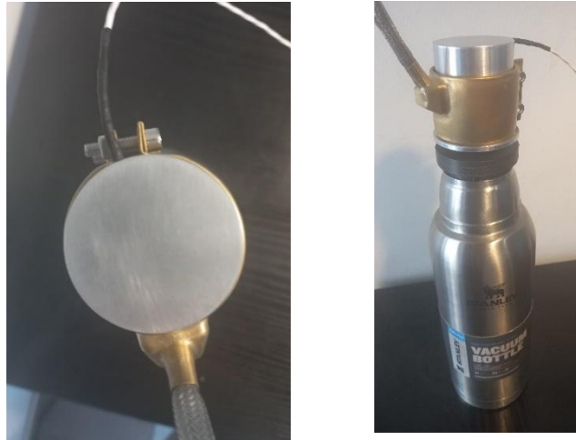
Figura 22: Dispositivo 2 y final con calefactor y sensor; vista superior y lateral.
