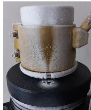
Figura 27: Rastro de bocanada de vapor en calefactor y superficie fría.
