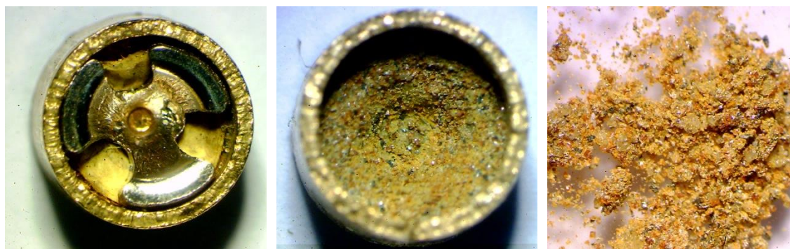
Figura 40: Cápsula iniciadora, la cual en su interior se encuentra el primer.
