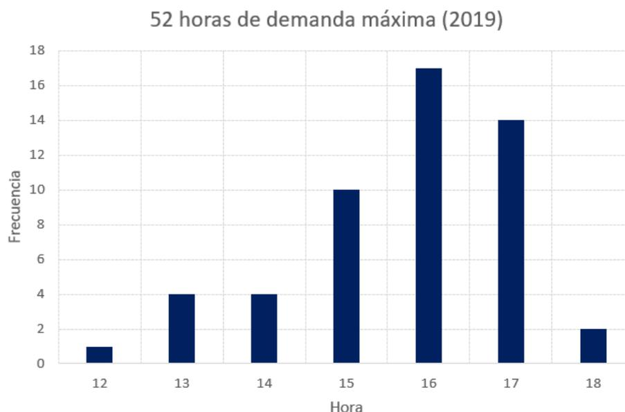
Fig. C.1: Horas de demanda de punta año 2020 de acuerdo a cálculo de potencia de suficiencia 2019
