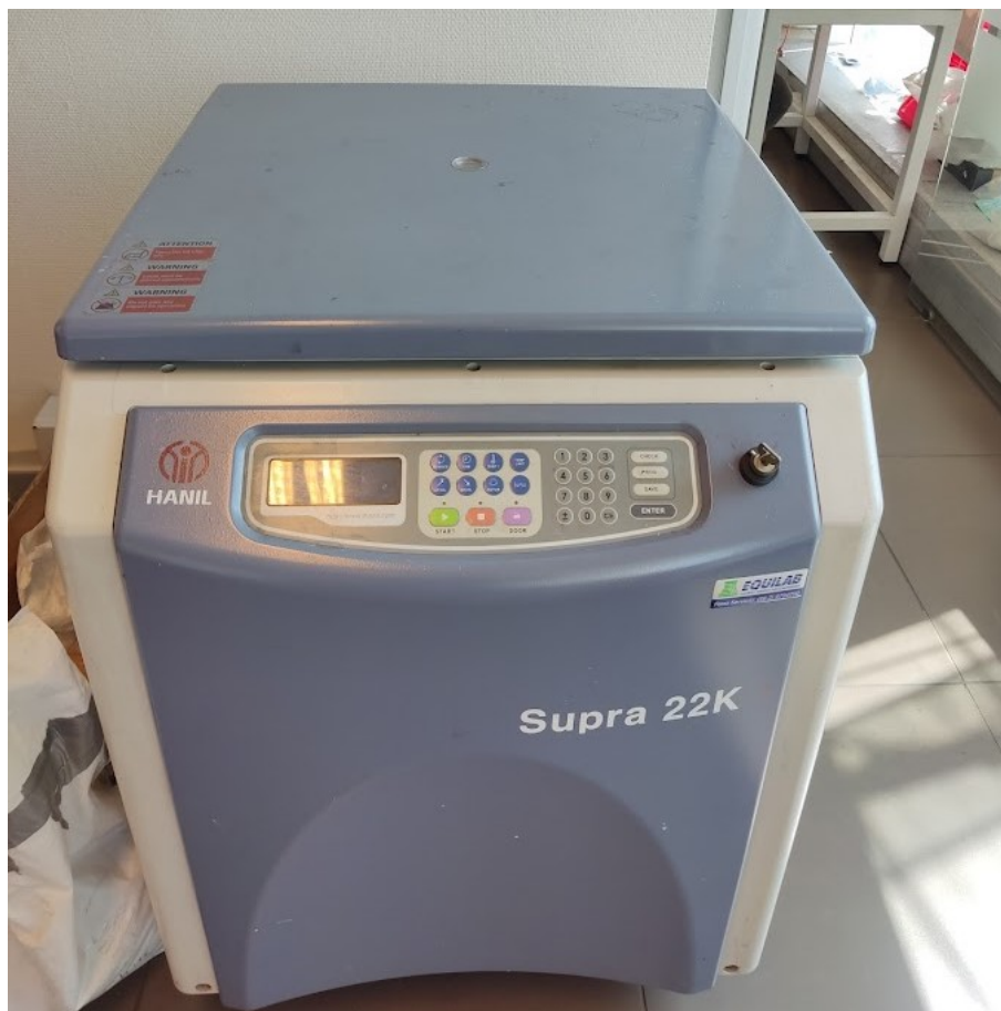
Figura 3.4: Centrífuga Supra 22K Hanil.
