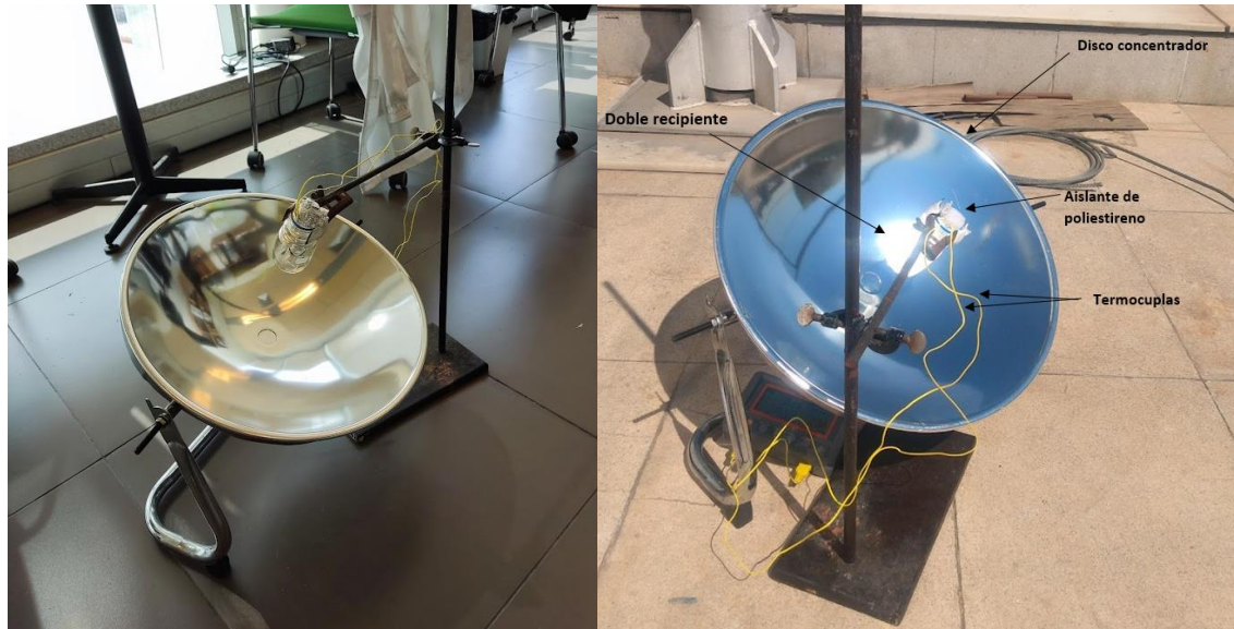
Figura 3.13: Montaje de equipo concentrador de radiación solar con un disco parabólico de factor 60.
