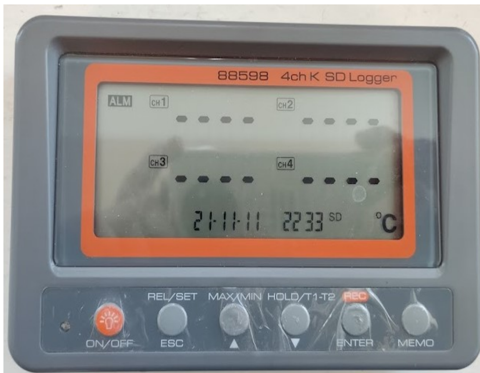
Figura 3.10: Termocupla de 4 canales "88598 AZ EB con memoria SD.
