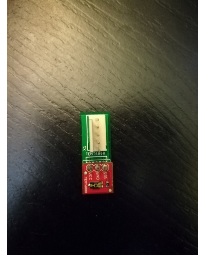
Figura 6.5: PCB de interfaz del sensor de luz.
