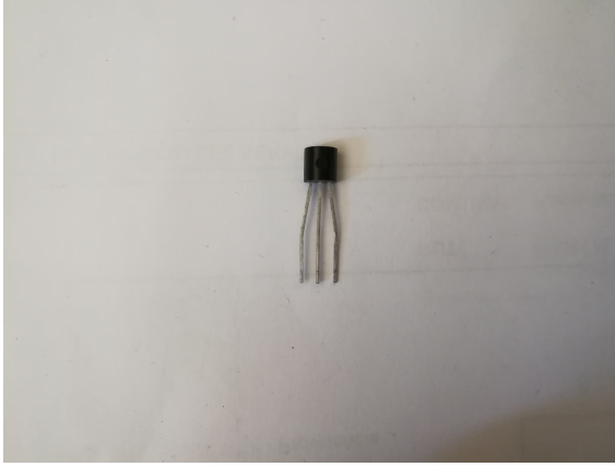
Figura 3.1: Sensor de temperatura DS18B20. Dimensiones: 5mm x 4mm x 12 mm.
