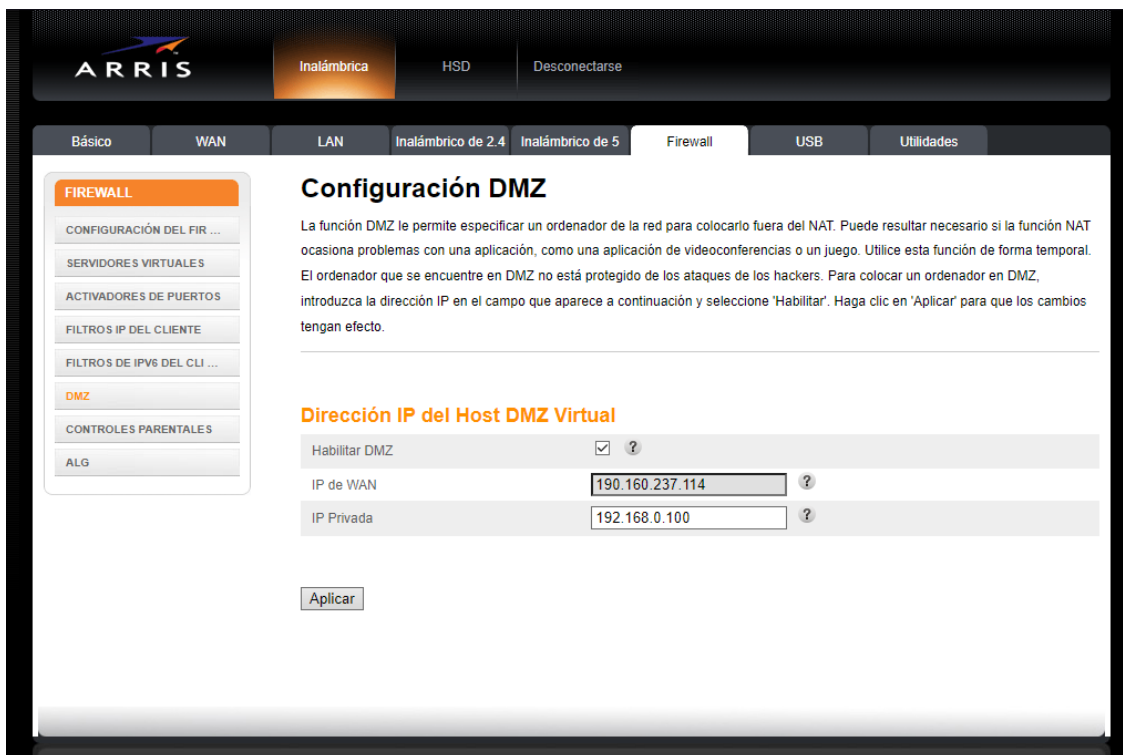
Figura C.4: Configuración del router para que la Raspberry Pi se ubique en la DMZ.
