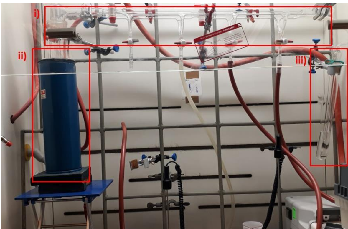
Figura 52: Configuración experimental de la línea Schlenk utilizada en la síntesis del COF-TpBpy según el procedimiento de la síntesis COF-ST2.
