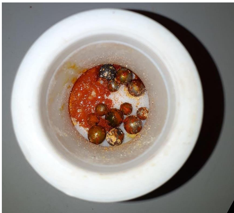
Figura 54: Fotografía del minuto 0 del procedimiento de la síntesis del COF TpBpy en molino de bolas con la utilización de solvente (COF-MBS2).
