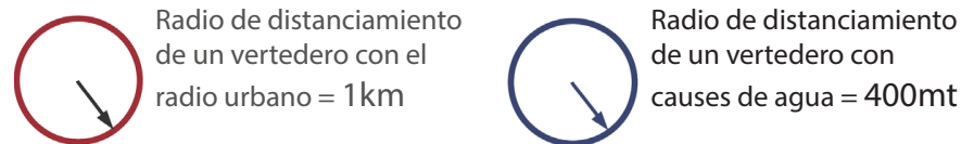
FIGURA 13: Radios de ubicación y condicionantes del emplazamiento para un vertedero rural (Elaboración propia a partir de definiciones del MMA 2016 y MINSAL,2008 )
