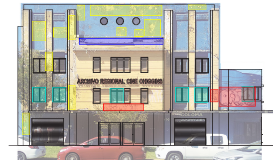
Daños e intervenciones fachada Av. Libertad. Esquema de elaboración propia
